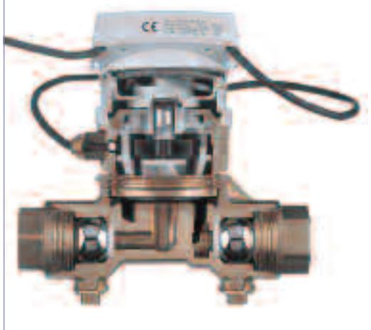
El **sonsonic® II** es un contador de turbina de chorro múltiple en el que se registra electrónicamente el giro de la turbina. Como cuando se aplica el principio de chorro múltiple se ven uniformemente cargados por la presión del agua tanto la turbina como la espiga de apoyo, el **sonsonic® II** presenta una estabilidad de medición muy elevada a lo largo de toda su duración de vida.
