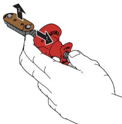
Fig. 130: Substituir o fusível térmico
