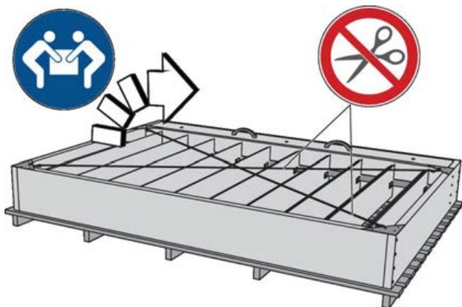
1. ▶ Desembalar registo e colocar no chão na vertical. Não retirar as cintas ainda. Cintas de fixação diagonais a partir de  $H \geq 1230$  x  $B \geq 700$
