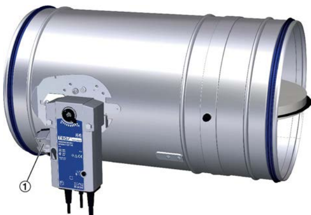
Fig. 40: Teste funcional (FKR-EU com atuador BFN ilustrado na posição ABERTO)
