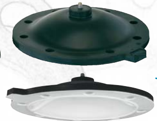
Diafragmas de cierre opcionalmente de EPDM, FPM, CR, CSM, NBR, PTFE
