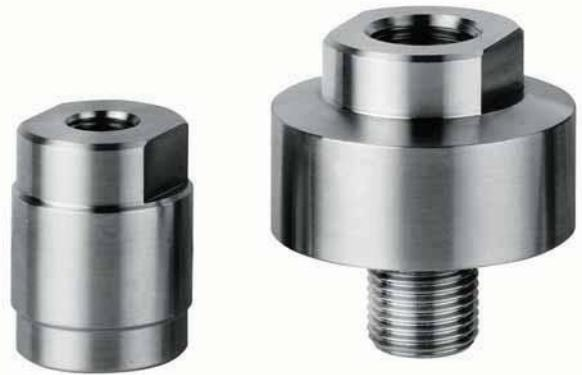
Projetados para isolar manômetros, pressostatos e transmissores de pressão do fluido do processo corrosivo, viscoso e sedimentoso. Uma membrana soldada e sobreposta é colocada à prova de vedação garantindo a separação do fluido de transmissão do processo. As ligações rosadas permitem o uso em todas as aplicações onde é importante a redução dimensional e onde são necessários instrumentos com diâmetro 63 mm.
