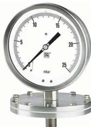
Elemento de medida é constituído por uma membrana elástica, com ondulações concêntricas, que aciona o mecanismo amplificador por meio de um eixo soldado à membrana. Realizados para medir pressão e depressão de fluidos viscosos, sedimentosos, cristalizáveis ou corrosivos. Comparando com os sistemas de mola tubular, são mais robustos e mais fáceis de proteger contra a sobrepressão ou fluidos corrosivos.
