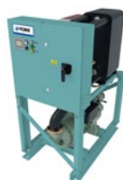
YCSE HP Bomba calor água-água Compr. parafuso / R134a (R513a a pedido) Água quente até 50°C Capacidade aquecimento: 170 a 300 kW
