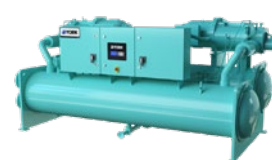
YVWH High Head HP Bomba calor água-água Compr. parafuso VSD / R1234ze Água quente até 80°C Capacidade aquecimento: 800 a 1600 kW
