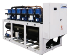
YWW Bomba calor água-água Compr. Scroll/ R454B Água quente até 50°C Compr. tornillo/ R1234ze Água quente até 65°C Capacidade aquecimento: 100 a 225 kW
