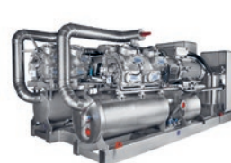
DualPAC recip 2-stages Velocidade Variável Comp. Recíproco / R717 Água quente até 90°C Capacidade aquecimento: 400 a 2900 kW
