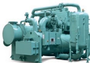
CYK HP Bomba de calor de água-água Compressores centrífugos duplos, arranjo em série / R1234ze Água quente até 93°C Capacidade aquecimento: 4000 a 10000 kW
