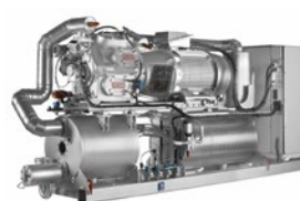
HeatPAC recip Velocidade Variável Comp. Recíproco / R717 Água quente até 90°C Capacidade aquecimento: até 2700 kW
