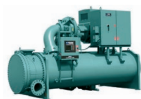
YK Bomba de calor de água-água Compressor centrífugo VSD / R1234ze Água quente até 68°C (Std) Água quente até 93°C (HP) Capacidade aquecimento: 1000 a 9000 kW
