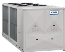
YTL Bomba calor ar-água Scroll / R454B Parafuso / R513A Água quente até 55°C Capacidade aquecimento: 202 a 1151 kW
