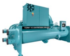
YZ Bomba calor água-água Compressor centrífugo VSD, mancais magnéticos R1233zd(E) Água quente até 45°C Capacidade aquecimento: 1000 a 6800 kW
