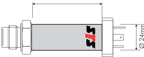
Versão para temperatura de fluidos até 125°C 25 mm para ficha DIN43650
